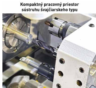
POROVNANIE PRIESTORU: PRIEMER OTVORU 11 MM Minimálny priemer obrábania 9 mm poskytuje extra voľný priestor pre lepší odvod triesok
