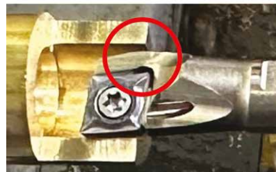
Štandardný typ s redukovaným priestorom pre odvod triesok
