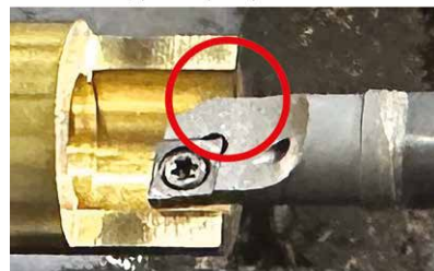
Štandardný typ s redukovaným priestorom pre odvod triesok
