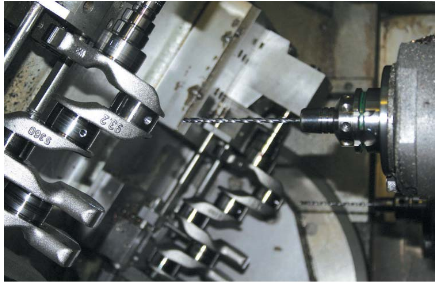
MPS1 - vrtanie hlbokého mazacieho otvoru od uloženia ojnicného ložiska k hlavnému ložisku kľukového hriadeľa na stroji Grob BZ530
