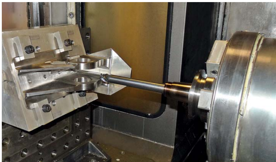
Na opracovanie výstuže boli použité iMX čelné stopkové frézy s vymeniteľnou hlavou od Mitsubishi Materials
