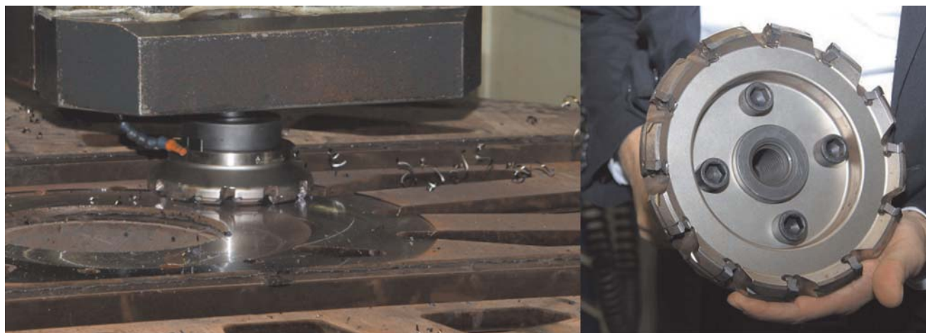
Problém vyriešený: Čelná fréza WSX445 od Mitsubishi Materials bola použitá na frézovanie veľkého a nestabilného prefabrikátu vyrobeného z ocele St52 procesom, ktorý bol extrémne efektívny a jednoduchý.
