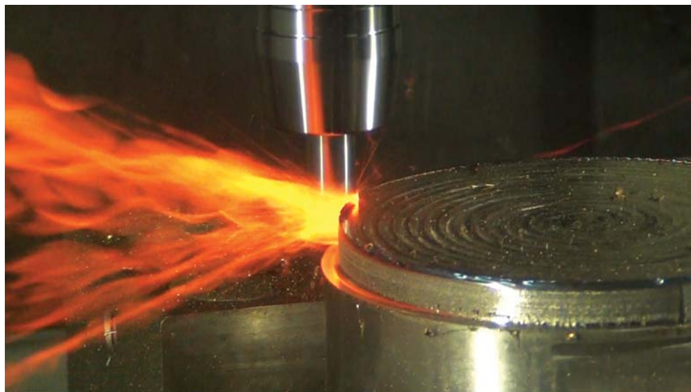
Keramické stopkové frézy - generujú extrémne teplo a zvládnu odoberať veľké objemy materiálu.
